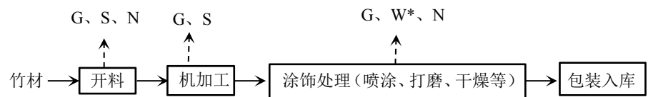
图 A. 3 典型三聚氰胺板家具生产工艺流程及污染物产生节点
