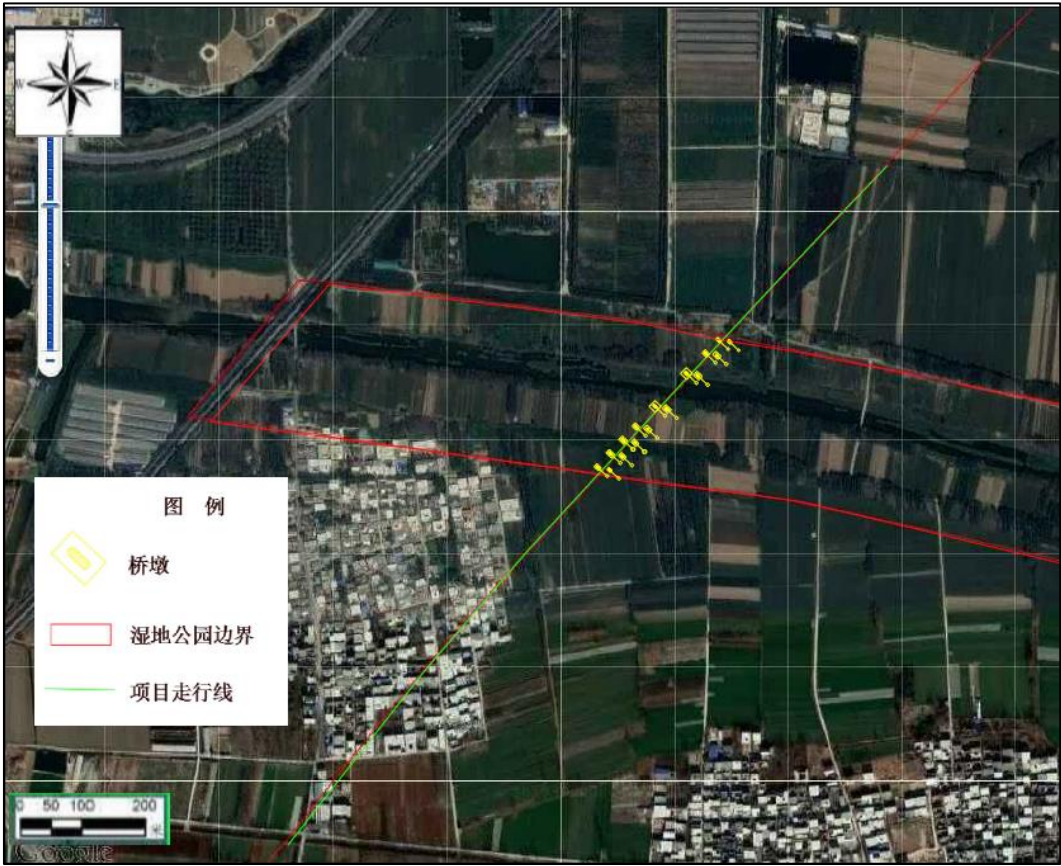
图 4.3-87 项目穿越万福河湿地公园桥墩布置图
