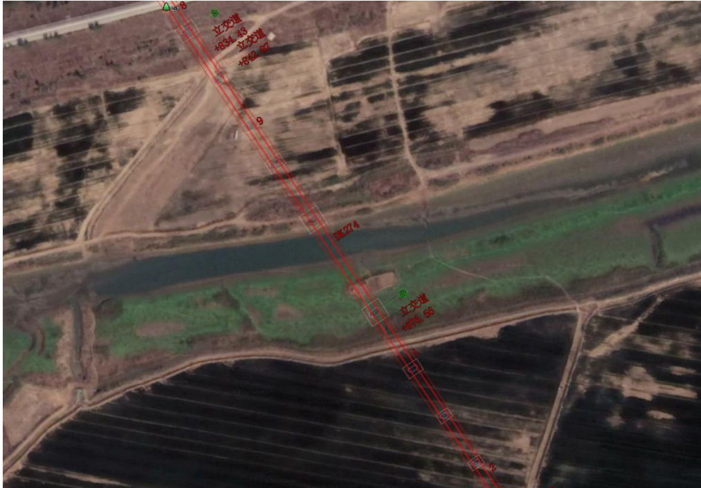
图 4.3-42 工程跨越滏阳新河桥墩布置图
